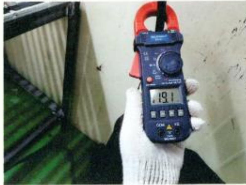
(b) 휴대용 전류계를 이용한 전류측정
