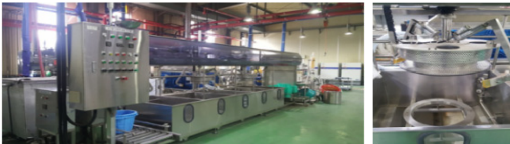
그림 17. 마이크로 버블 세척 장치(한국식품연구원)
