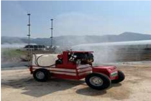
그림 17. 엽면시비기 분무노즐 장착 시제품 II
