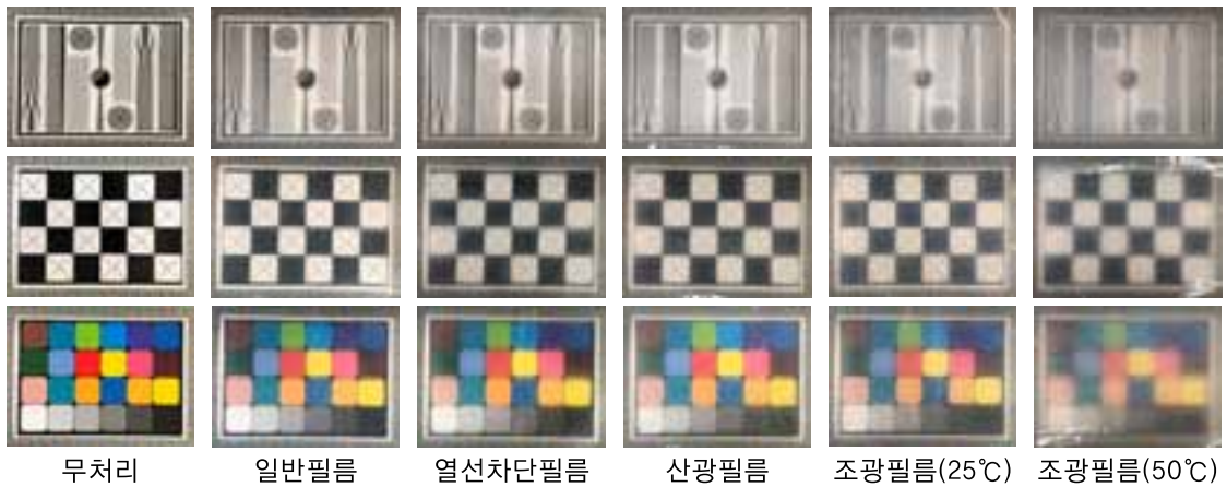
4그림 6. 필름 종류와 표면온도에 따른 흐림도
