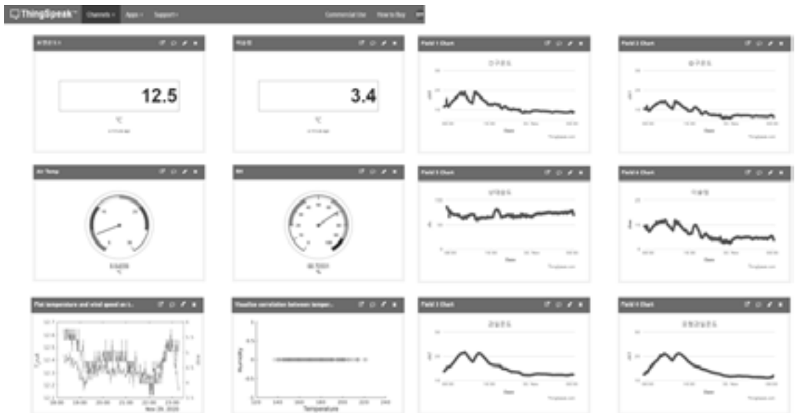
그림 48. 온실환경 및 과실온도 모니터링 대시보드
